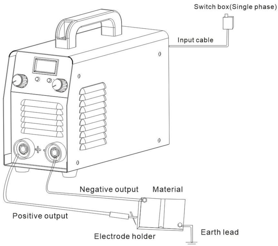
5. La perilla de impulsión de arco se usa para ajustar la función de soldadura, especialmente en arreglos de baja corriente, que se coopera con la perilla de ajuste de corriente de soldadura, pueden ajustar la corriente de arco y estar fuera de control de la perilla de ajuste de corriente de soldadura. Entonces, la máquina puede granular energía poderosa y empujar la corriente para lograr el efecto que puede.
